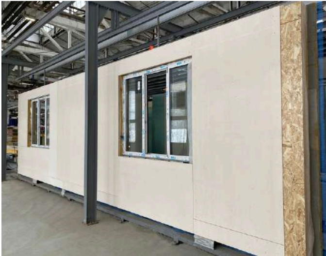
Внутренняя часть наружной стеновой панели
