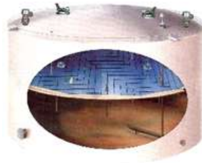
Резервуар вертикальный стальной со стационарной крышей и понтоном (РВСП)
