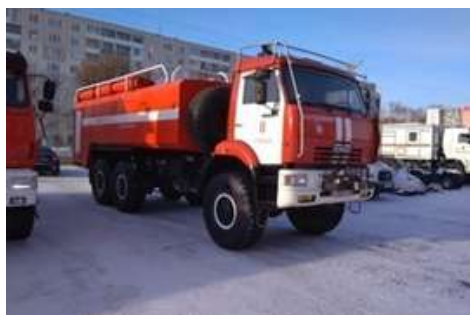
Автоцистерна пожарная специальная АЦС 18,0 (65222) на базе шасси Камаз-65222
