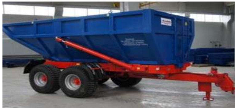
Полуприцеп тракторный для жидких фракций ПТСЖ-12
