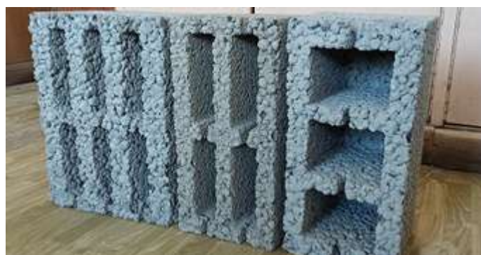
Керамзитобетонные блоки (Керамзитоблок): 390-188-190 мм / 390-188-290мм
