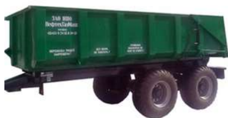
Полуприцеп тракторный самосвальный НГМ 003 грузоподъемностью 18 т.
