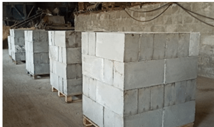
Foamed concrete blocks: 600-300-200 mm/ 400-300-200 mm / 600-300-100 mm
