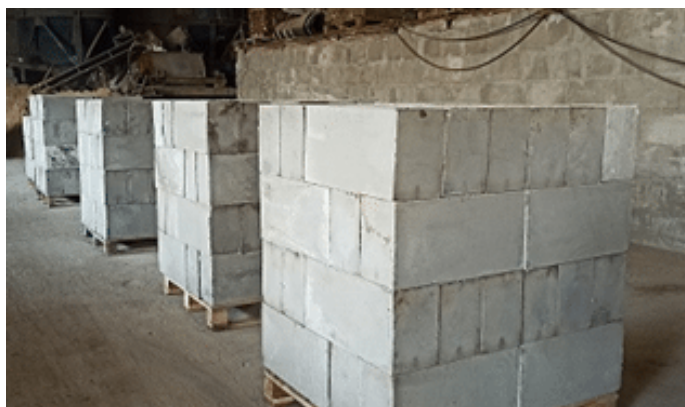
Пенобетонные блоки (Пеноблок): 600-300-200 мм / 400-300-200 мм / 600-300-100 мм
